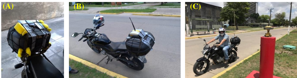
Figura 29 – Estrutura captação dados GPS 10hz a) Estrutura de fixação do GPS b) Fixação do GPS na estrutura c) GPS fixo para correção de posição e GPS móvel
